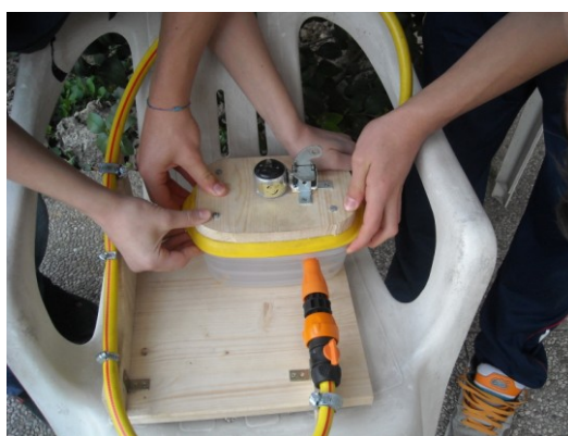
6. MONTAGGIO DELLA TURBINA CON ALTERNATORE ALLA SCATOLA
