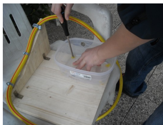
4. MONTAGGIO DELLA SCATOLA AL PIANO IN LEGNO
