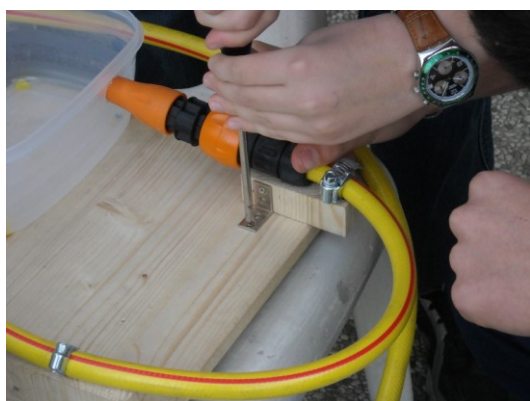
5. MONTAGGIO DEL TUBO AL PIANO IN LEGNO
