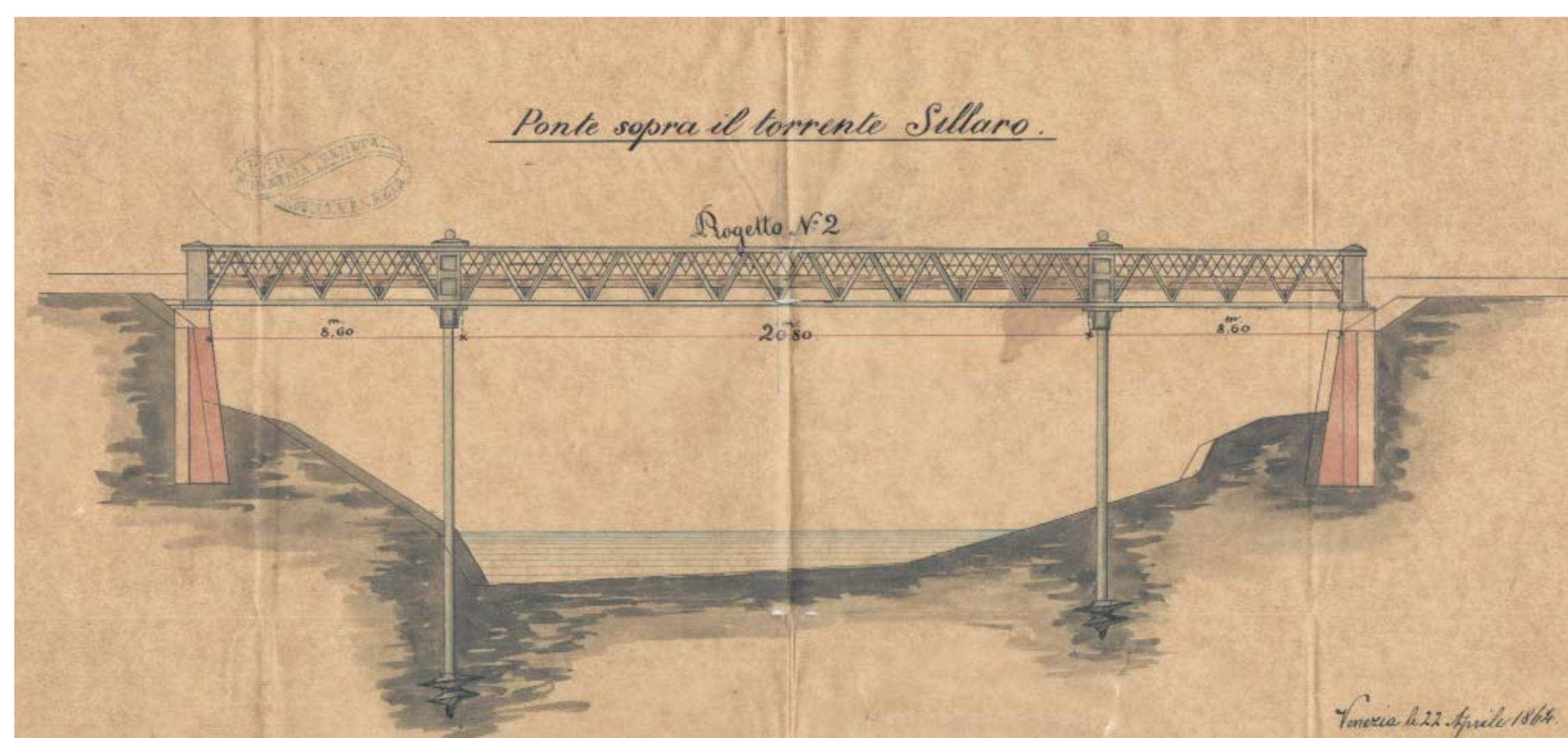
Prospetto della prima soluzione in ferro e muratura, proposta per la costruzione del ponte sul torrente Sillaro, sulla strada del Tiglio a Sesto Imolese, dalla ditta Neville di Venezia, 22 aprile 1864 (ASPB)
