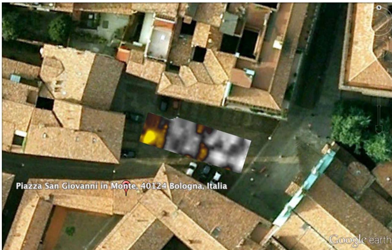
Figura 2. Risultati dell'indagine georadar in Piazza San Giovanni in Monte. La mappa è relativa a una profondità stimata dal p.c. di m 0.50-0.70 ca. In giallo sono le sorgenti di riflessione del segnale radar caratterizzate da una più alta amplificazione.
